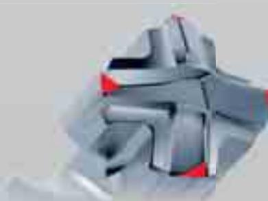
Le foret Nemesis assure un perçage rapide dans le béton armé et les pierres les plus dures. Sa tête symétrique monobloc en carbure et sa pointe de précision garantissent un perçage précis. La conception du foret Nemesis permet une augmentation de 50% du nombre de trous percés par rapport à un foret standard. L'hélice robuste à quatre spirales évacue un maximum de poussières et limite les vibrations.
